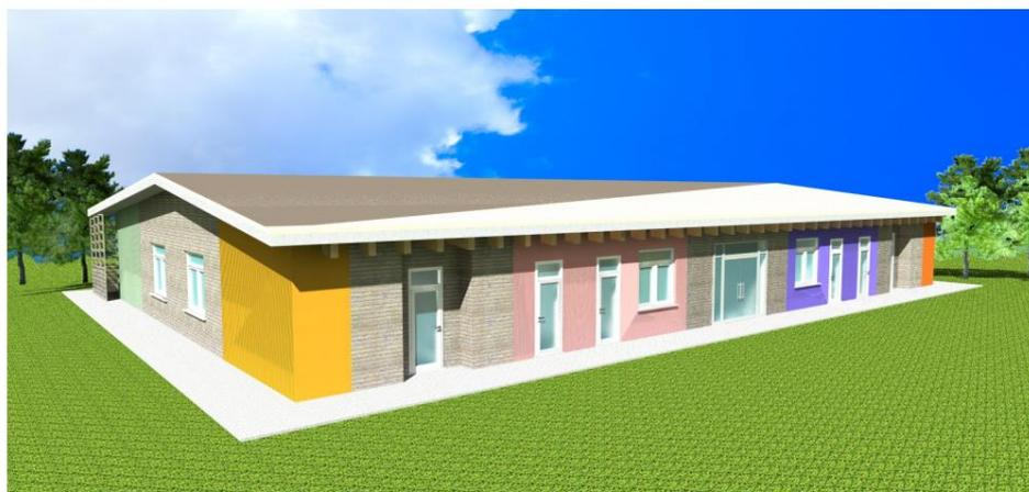
Le caratteristiche strutturali dell'edificio sono volte all'ottenimento della massima sicurezza in particolare nei confronti delle azioni sismiche. Si propone una struttura in pannelli di legno tipo Xlam con una struttura di fondazione a platea in calcestruzzo armato. La copertura del fabbricato sarà realizzata mediante travi in legno lamellare alle quali verrà fissato un doppio tavolato incrociato al fine di conseguire un adeguato comportamento scatolare del fabbricato.
